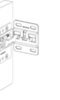
Gli elementi pensile e base sospesa sono attrezzati con ferramenta professionale di fissaggio a parete (vedi dettaglio sopra). Si tratta di attaccaglie metalliche con capsula di copertura, di portata superiore ai 150 kg.\* ad elemento, molto adatti quindi sia ad utilizzo pensile che base sospesa.
